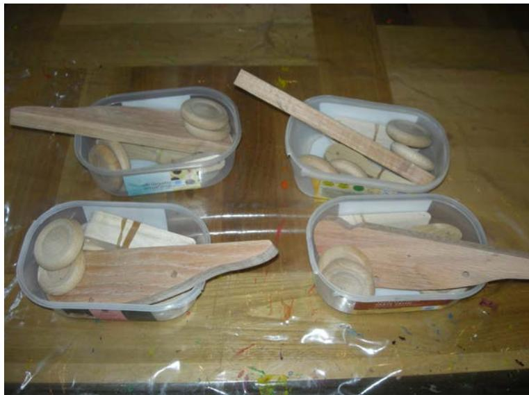
Poncer au grain 500 ; insister sur les champs et casser « très légèrement » les arêtes (je préfère cette technique à la fraise ¼ de rond montée sur la défonceuse ; l'épaisseur des éléments ne s'y prête guère et puis...ça va plus vite !).
