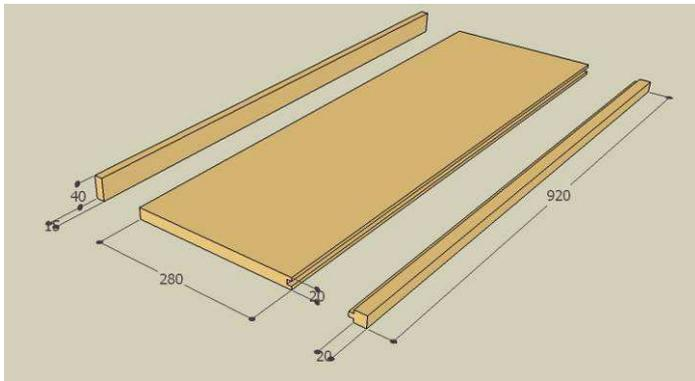
Les montants et étagères sont réalisés par assemblage à entures multiples. Les faces avant sont rainurées afin de recevoir des alèzes teintées pour « faire plus joli ».
