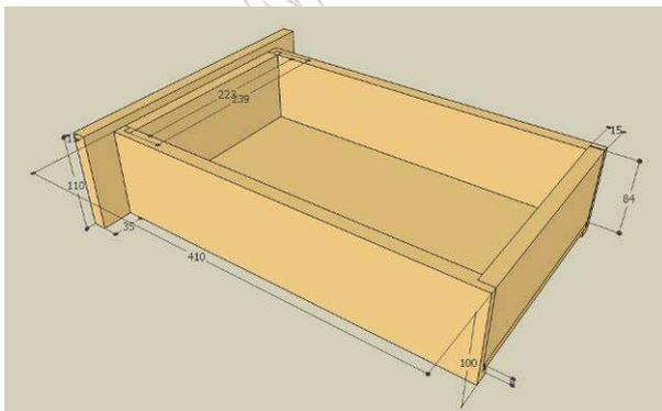
Le tiroir. Compte tenu du faible volume, le type d'assemblage retenu est largement suffisant. Les étagères sont montées sur tasseaux et vissées.
