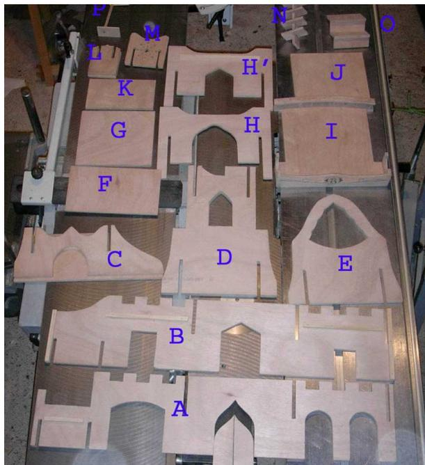
Les différents éléments du château sont assemblés par emboîtement ce qui permettra un montage et un démontage aisés.
