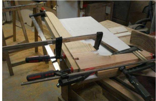
Assemblage à 90° sur gabarit de montage
