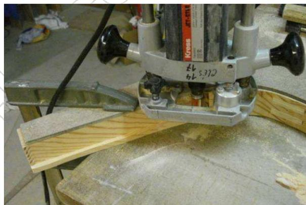
Pour la fabrication des gabarits, il faut savoir que les formes creuses (concaves) sont plus difficilement réalisables que celles qui ne sont pas creuses (convexes) ; ces dernières pouvant être facilement ajustées à la ponceuse à bande ou autre. Pour les formes creuses, j'ai employé un gros cylindre ponceur « maison » (voir le dossier de JFT68 sur ce site).
