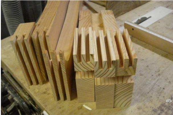
Rainures réalisées avec la lame Ténor
