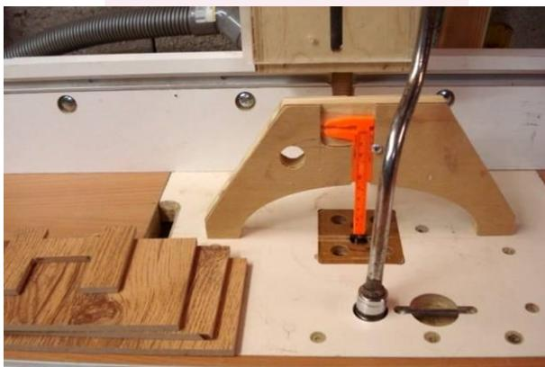
Une fois les pièces découpées, vous réglez la hauteur d'une fraise de 6mm sur 2,5 mm et le guide sur 10 mm. Toutes les rainures se font avec ce même réglage (10 mm du bord et 2,5 mm de profondeur). Sur le socle et les 2 côtés, fraisez une rainure à +/- 60 mm du bout pour la pièce de séparation. (ci-contre, réglage de la hauteur de fraise sur la table de défonçage à ascenseur)
