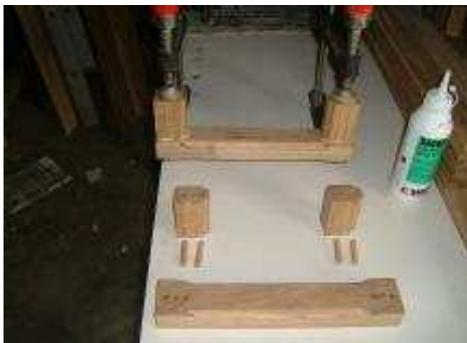
Les petites lisses latérales ont été réalisées conjointement aux grandes lisses. Elles sont assemblées avec les poteaux et les plaques de fixation à l'aide de tourillons et par collage. Pour renforcer et sécuriser cet ensemble, deux vis de 6 X 90 à tête fraisée traversent la plaque et les petites lisses et sont vissées dans le poteau.
