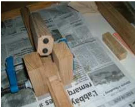
Ils ont été rabotés en épaisseur en même temps que les lisses. Ils comportent quatre goujures de 6 pour le raccordement avec les lisses. Ils comportent à chaque extrémité deux trous de 8X22 percés par retournement sur une mortaiseuse avec un foret à métaux avec hélice à gauche.
