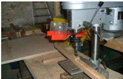
Il est effectué sur une perceuse à colonne avec un foret à bois dont la pointe se centre dans le pointage réalisé à l'étape précédente.
