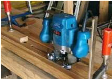
Placer de chaque côté de la rainure des butées qui limiteront le déplacement de la défonceuse. Placer un tasseau entre le montage et l'établi. Serrer l'ensemble avec un serre-joint. J'ai ouvert les rainures avec une fraise de 12 mm en plusieurs passes. La finition a été effectuée avec une fraise de 12,7 mm grande longueur, en une seule passe. Résultat très bon.
