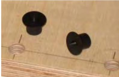
Il faut percer deux trous de 10 mm de diamètre pour les tourillons
