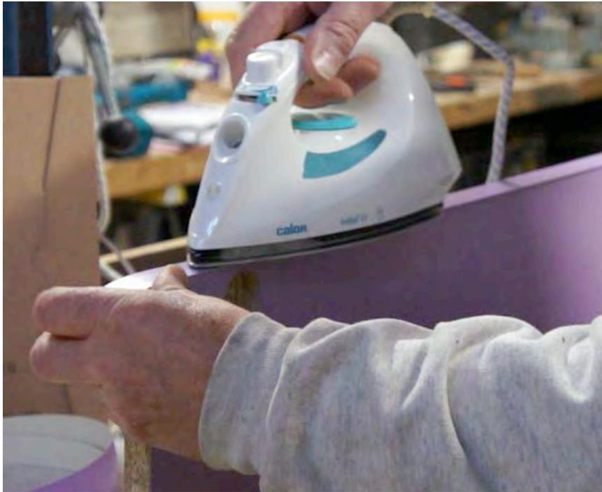
Les bandes de chant utilisées sont thermo-adhésives et sont collées à l'aide d'un fer à repasser que j'ai réglé à environ 180°C. C'est une opération qui demande un peu d'attention au début. Il ne faut aller ni trop vite (ça ne colle pas) ni trop lentement (la bande cloque). Il ne faut pas hésiter à faire un ou deux essais. L'interposition d'un tissu entre la semelle du fer et la bande permet de tempérer et d'éviter les traces du fer qui peuvent apparaître sur la bande.
