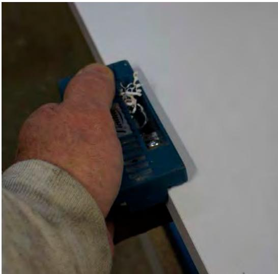
Pour affleurer les chants j'ai utilisé une araseuse manuelle (Virutex) avec finition à la lime fine.
