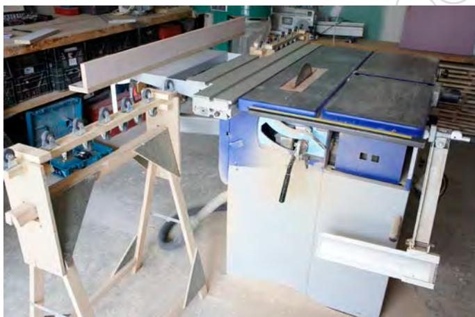
Il se fait à la déligneuse du combiné. La lame utilisée est une lame à 80 dents au carbure et parfaitement affûtée afin d'éviter les éclats. L'avance doit se faire à vitesse lente et régulière ce qui n'est pas toujours évident pour certains éléments longs. Pour les éléments de largeur supérieure à 38 cm j'ai utilisé un guide fixé sur le chariot ainsi que des servantes bricolées à partir de tréteaux et de roulettes.
