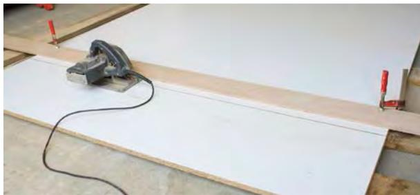
Il se fait à partir du plan de débit des panneaux. Travaillant seul, le débit est fait à la scie circulaire. Les panneaux sont posés à plat au sol. La découpe se fait, avec une sur-cote de 2 cm environ sur tous les côtés. L'utilisation d'une règle permet d'obtenir un chant quasi parfait sur au moins un chant de la pièce
