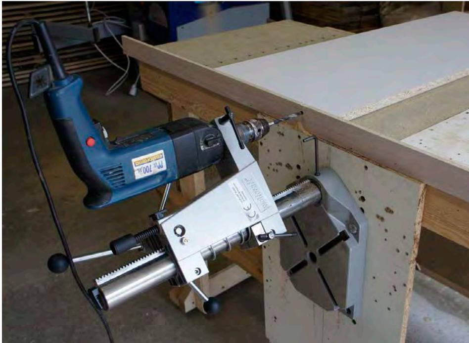
Pour les percements, j'ai utilisé une perceuse courante montée sur une colonne et fixée sur une table. Elle a été retournée à 90° pour les percements sur chant. L'avantage de cette colonne c'est qu'elle peut pivoter à 360° sur son socle car elle n'est maintenue que par une vis allen.
