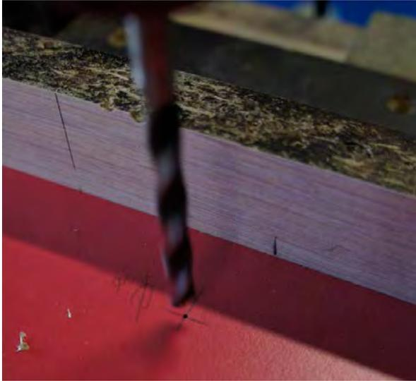
Les cotes de perçement et de positionnement des différents organes de liaison sont données par les fiches du fabricant (annexe 1). Le traçage consiste à repérer les axes des différents percements à effectuer sur les faces et chants des différents éléments. Sur le plat, je les matérialise par un poinçonnement ce qui permet de les positionner précisément sous la mèche lors de perçage dans le cas où il n'est pas utilisé de butées.
