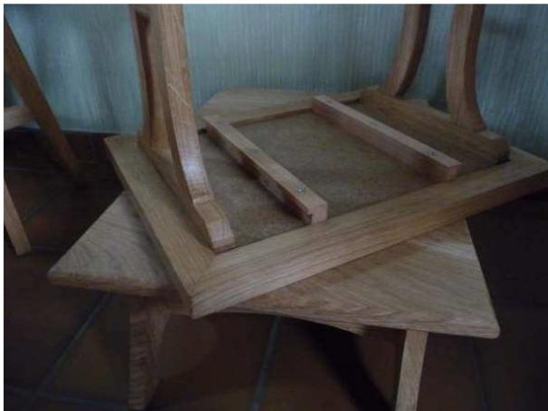
Le piètement est fixé au plateau par vissage. Comme celui-ci s'effectue dans le panneau d'aggloméré, on peut mettre quatre vis comme indiqué dans les schémas.
