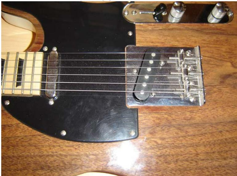
2 micros simple bobinage (ici sur une 'Fender Telecaster custom' DIY).
