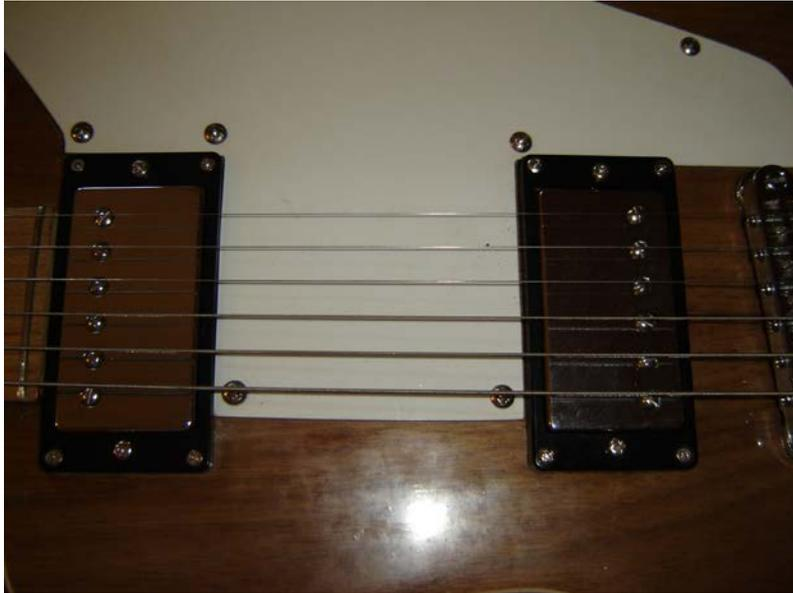
2 micros double bobinage (ici sur une 'Gibson Explorer custom' DIY).
