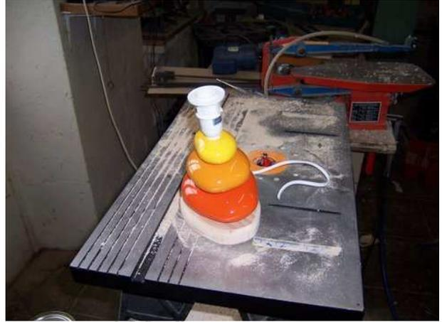
9) une dernière opération consiste à **assembler le pied au socle** en prévoyant bien sûr le passage du fil électrique. Le mien tient avec 3 vis à bois de 80 mm. Le fil est collé dans la saignée, effectuée à la défonceuse, puis agrafé.
