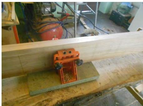
Voici le matériel utilisé pour faire les avant trous permettant d'utiliser des vis baises.
