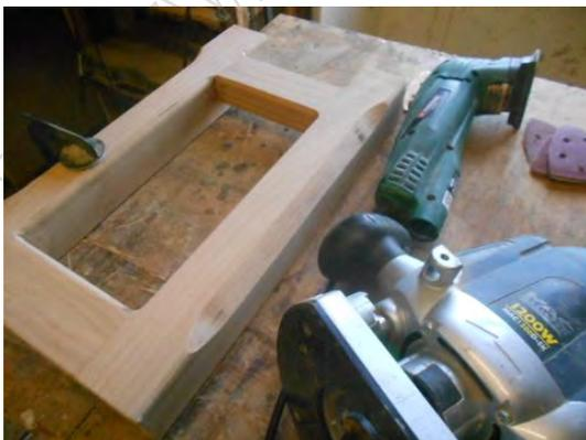
Avec la défonceuse, j'ai arrondi les bords intérieurs et réalisé une moulure arrêtée sur la partie extérieure des pieds.
