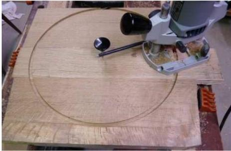
La forme circulaire est obtenue en utilisant la défonceuse et le compas livré avec cette défonceuse. Comme la pointe va laisser une trace, on opère côté contre parement. Si vous n'en n'avez pas, Santé vous en propose sur ce site (rubrique Trucs et Astuces).
