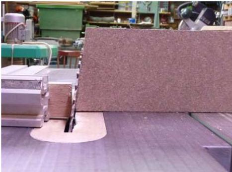
Utiliser ce que l'on vient de couper pour régler l'angle de la scie.
