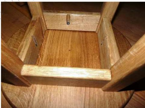
La fixation de l'assise sur le piétement est réalisée avec 4 vis biaises. Sur la photo, on remarquera le trou laissé par la pointe lors de la découpe du disque.
