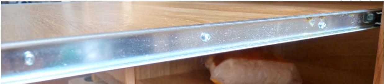
Des trous ont été percés dans cette partie (pour un tiroir, elle est prévue pour être fixée dans la rainure du tiroir). Le rail est fixé sur le plateau avec des vis à têtes rondes.
