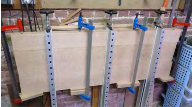
Plateau en cours de collage : utilisation de la presse Plano avec ajout de serre-joints.
