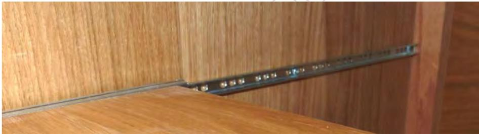
L'autre partie est fixée sur les panneaux intermédiaires. C'est l'opération qui demande le plus de soins. Dans des chutes, je m'étais fabriqué des piges qui permettaient de maintenir le plateau en bonne position.
