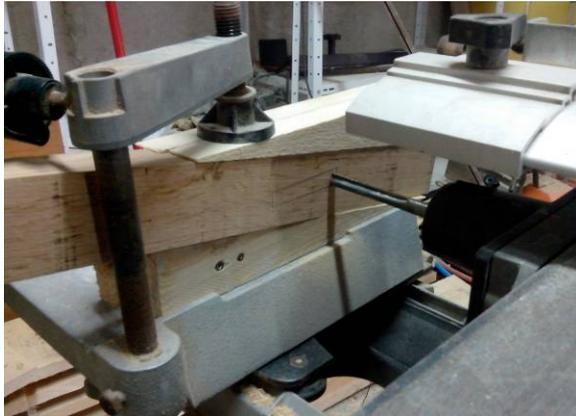
Après il a fallu que je fasse les mortaises dans les montants afin de pouvoir fixer ce dossier. J'ai fait des cales triangulaires dans des chutes afin de pouvoir réaliser des mortaises inclinées pour donner un angle confortable au dossier.
