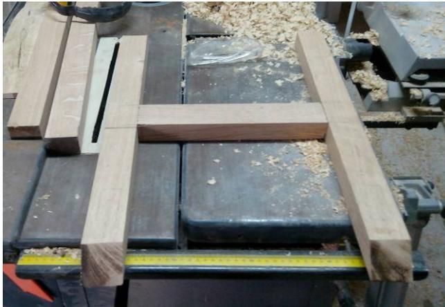
Pour réaliser le socle, j'ai coupé les montants rabotés à 45° à la scie circulaire de ma combinée (la lame a sérieusement besoin d'être affûtée, ça se voit aux marques noires sur la photo).
