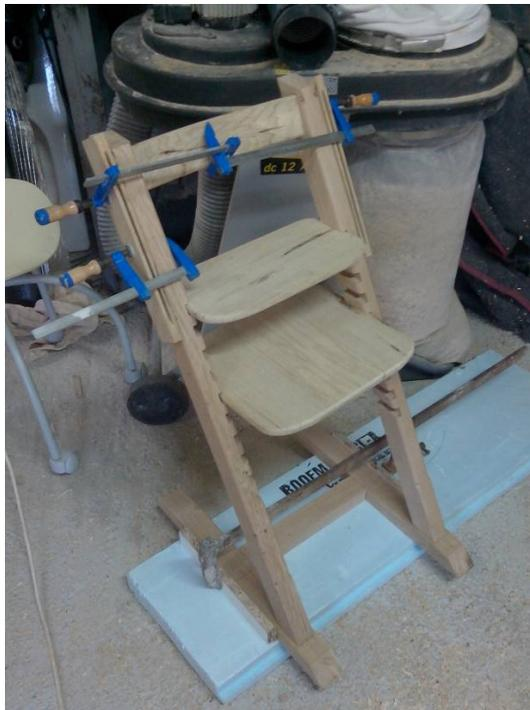
Ensuite j'ai fait l'assemblage, c'est à dire collé le dossier et la liaison au niveau du socle.
