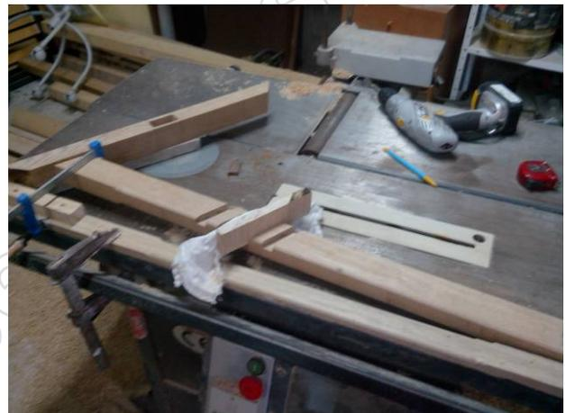
J'ai utilisé des cales pour immobiliser le tout sur la combinée car je ne dispose pas encore d'établi.
