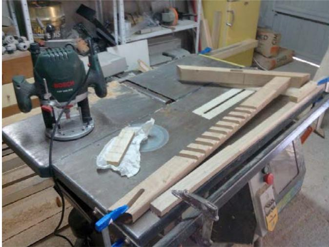
Puis il a fallu réaliser les rainures dans lesquelles les tablettes viennent s'insérer.
