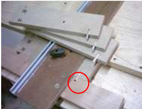
Différentes entretoises, avec les doigts de positionnement.
