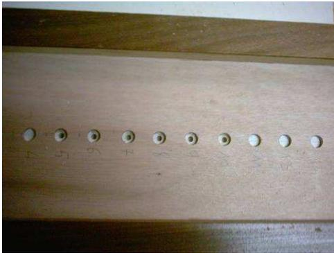
L'utilisation se fera de la même façon que pour percer les trous de 12 mais avec une fraise dont le diamètre correspondra au diamètre des taquets supports d'étagères. Ces trous seront percés, espacés de 32mm, au centre des trous de 12 du rail (voir photo ci-dessous)
