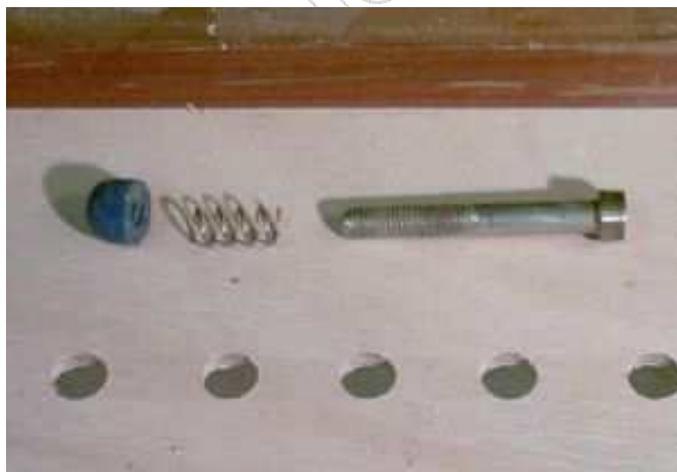
tête du boulon dépasse d'environ 13mm la base du bloc de bois et que, lorsqu'on appuie sur le bout du plat, la tête du boulon remonte d'environ 10mm. Posez une petite vis à bois dans le trou de 6, sans serrer, afin d'empêcher le levier de tourner.
