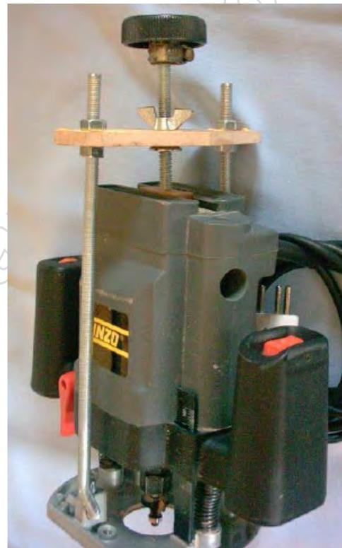
Il sera parfois nécessaire d'intercaler une plaque d'appui entre la tige filetée et la défonceuse en veillant à ne pas boucher les ouïes d'aération du moteur.
