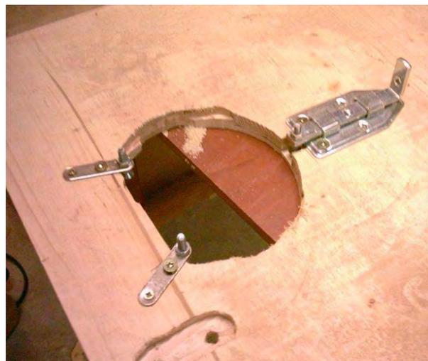
Il faudra en plus, défoncer une petite rainure à l'avant du verrou afin de pouvoir escamoter complètement le support avant, et permettre ainsi la pose et la dépose aisée de la défonceuse.
