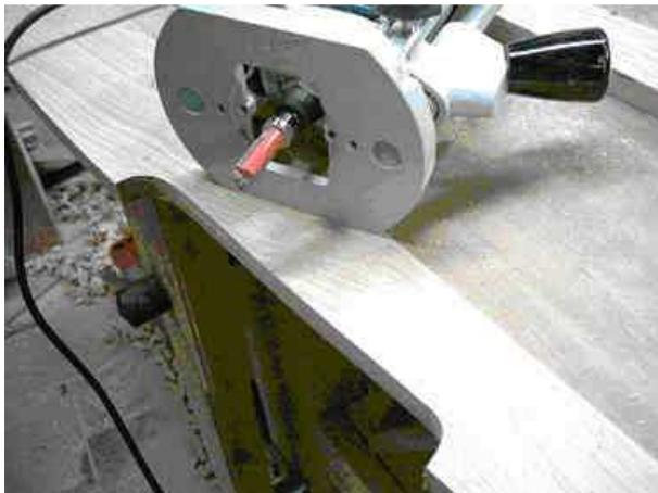
Il faut, bien sûr, couper quelques mm à côté de la découpe de la fraise et terminer à la fraise à copier (avec roulement sur la queue).
