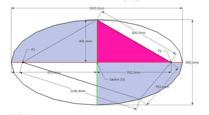
Tout d'abord, la longueur de la ficelle : dans tous les cas, la ficelle doit être égale au grand diamètre de l'ellipse, soit dans l'exemple ci-dessus, 1600 mm.
