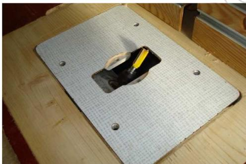
Ci-dessus, la défonceuse alu dans toute sa splendeur et, ci-contre la même placée sous table. Vous remarquez le défonçage pour la bague de copiage (pour le travail à 90°, bien sûr !) ou une plaque de remplissage du trou. Vous pouvez remarquer aussi les 4 trous filetés permettant de fixer des accessoires comme un guide parallèle.
