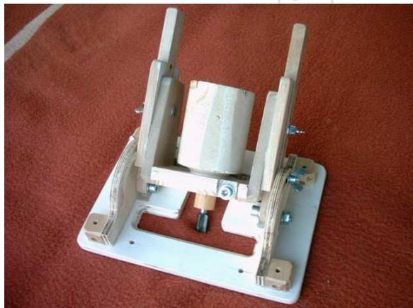
De là m'est venue l'idée de fabriquer une défonceuse à semelle inclinable.
