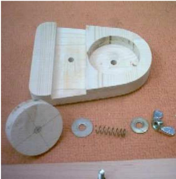
Afin de maintenir un contact permanent entre le pivot collé et la partie mobile j'ai fileté le bout de l'axe pour y fixer un ressort assurant le contact. Je pense que ce ressort n'est pas absolument nécessaire et que l'on pourrait s'en passer mais c'est quand même une sécurité.
