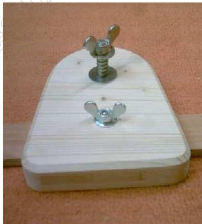
Sur la verge, on aura percé des trous tous les 10 cm pour le réglage grossier du rayon de la courbe à défoncer, le réglage fin se fait par le déplacement de la défonceuse sur la verge.
