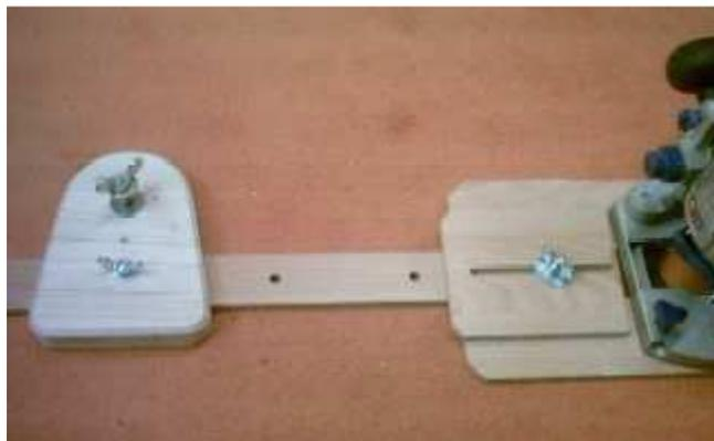
Le centre et la verge qui y est associée s'adaptent sur le compas et remplacent la verge munie d'une pointe.
