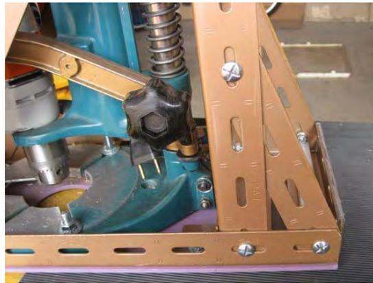
Les deux morceaux plats découpés vont être légèrement cintrés. Il conviendra d'abord de les redresser (en appuyant fortement sur l'arête de l'établi, par exemple) avant de les boulonner.
