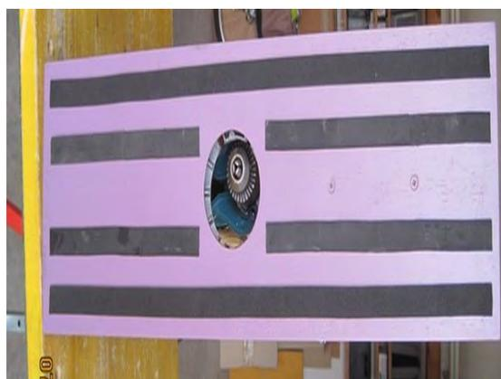
On collera quatre bandes parallèles sur la face inférieure du socle.
