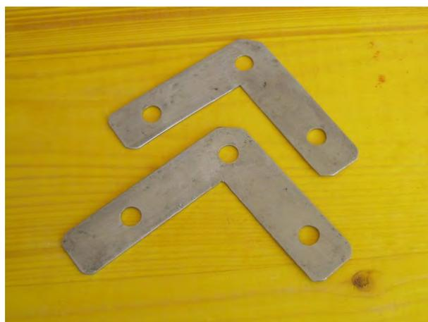
Confectionner deux équerres d'angle dans de la tôle de 0,5 d'épaisseur., longueur 80, largeur 20.
