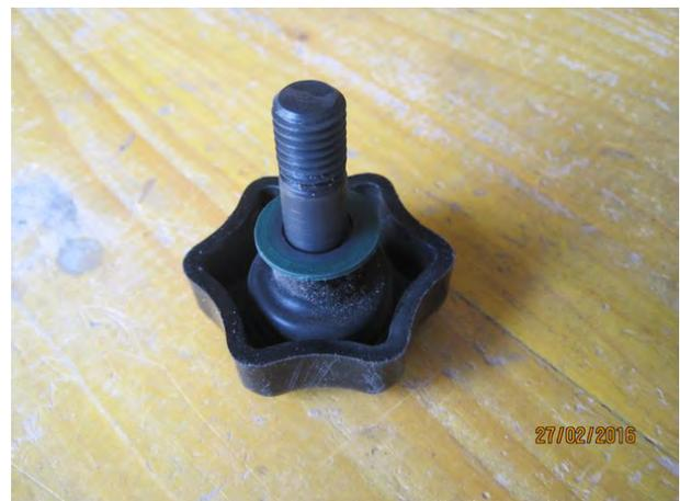
Si l'on possède le modèle muni d'une tige métallique, il est préférable de remplacer cette dernière par une tige plus longue (120 mm).
