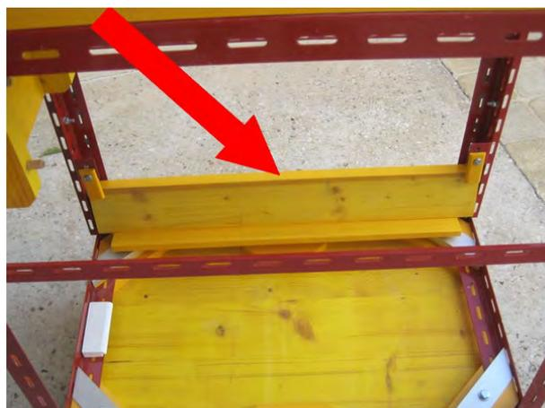
Il se range sur le socle, au fond, en longueur, maintenu par deux supports tournants constitués d'une chute de cornière de 45 de longueur et d'un morceau de tasseau 5 x 30 de 65 de longueur.
