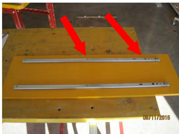
On utilise des glissières pour tiroir de 550 de longueur à sortie partielle. J'ai utilisé un modèle de 17 de largeur qui est suffisant pour supporter le poids du support seul, sans le pavé...
