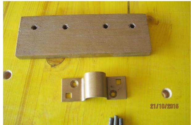
Sur le devant, il convient de maintenir solidement la colonne du support de perçage en position verticale. Sa seule fixation à sa base est insuffisante : sous l'effort du perçage, la colonne aurait tendance à basculer vers l'arrière.
