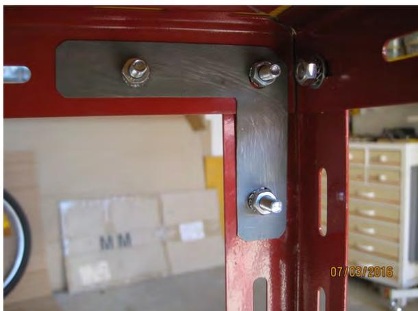
Vérifier l'équerrage, boulonner les équerres d'angle, en haut sur deux angles opposés en diagonale.
