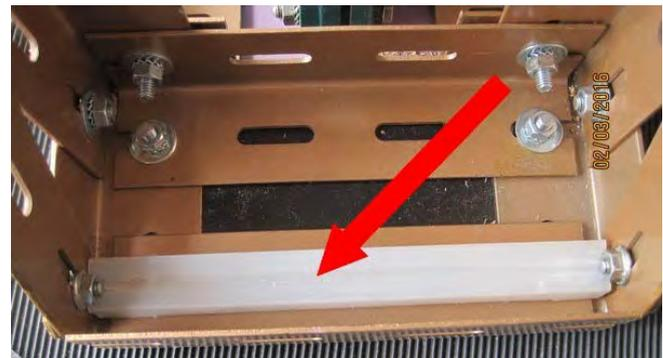
Inutile de la coller, les écrous des montants latéraux la maintiendront en place. Cette cornière a pour fonction d'incliner le pavé de pierre contre les montants verticaux.
