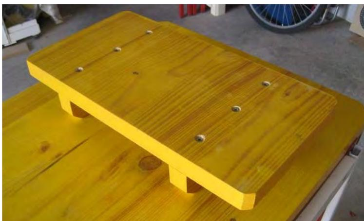
Placer la rehausse sur le plateau, au centre à 110 du bord droit. Marquer l'emplacement des trous. Percer les 4 trous au  $\text{Ø}10,5$ .
