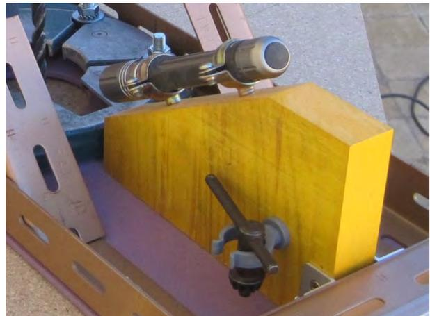
Le support jaune est fixé au centre du socle par deux vis à bois de 4 x 25 traversantes. Les deux équerres sont vissées en bas du côté de 120 par deux vis 4 x 15. Elles sont boulonnées sur la cornière métallique de l'extrémité avant du support (boulons 6 x 12).
