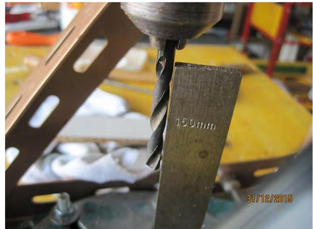
Ce n'est pas facile à contrôler : j'ai utilisé un niveau fixé sur la colonne et une bonne équerre. Apparemment, c'est correct !
