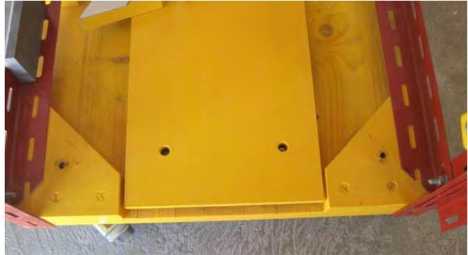
Visser le dessous des coulisses sur le fond de la servante à 90 des bords latéraux. Utiliser les deux trous du chariot pour passer le tournevis et accéder ainsi aux deux vis des extrémités. Le chariot vient en butée contre la cornière du côté gauche. Il doit être centré dans le passage entre les pièces triangulaires des angles du côté droit.
