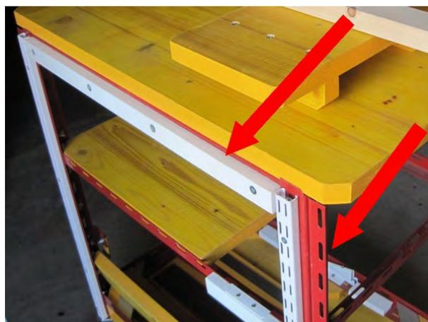
Les 2 équerres de 130 sont coupées à 95 de longueur. L'intérieur est rempli d'un morceau de bois vissé. Sur la partie supérieure percer un trou Ø10 de 20 de profondeur situé à 30 de l'extrémité.
