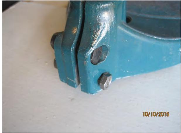
Pour renforcer la fixation de la colonne, percer puis ajouter un deuxième boulon  $\text{Ø}6$  en bas de celle-ci, juste au-dessous de celui existant.
