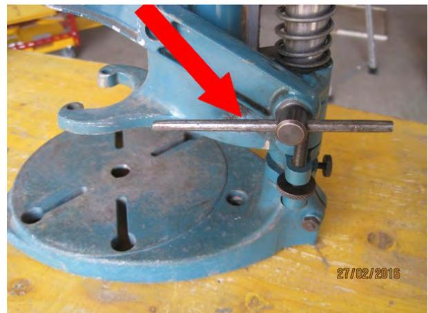
Il convient également d'ajouter une deuxième rondelle, métallique celle-là, sur l'axe du bras de levier devant la pièce coulissante en téflon, toujours pour limiter le jeu latéral.
