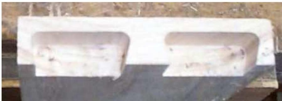
Pour réaliser ce type d'assemblage le gabarit pour réaliser les queues "mâles" est le même, une modification du gabarit permettant la réalisation de queue d'aronde "femelles" va être nécessaire mais minimale : il s'agit tout simplement d'y ajouter une butée réglable permettant l'arrêt de la queue et une butée permettant le réglage de la défonceuse voir photo ci-dessous :
