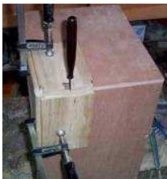
Tracez sur les bouts des pièces devant recevoir les queues femelles l'emplacement de celles-ci, en plaçant dessus la pièce fraisée avec des queues "mâles" et en reportant celles-ci sur le bout de la pièce avec une pointe à tracer ou au crayon, ce traçage est rendu plus précis et facile avec le montage ci-contre..
