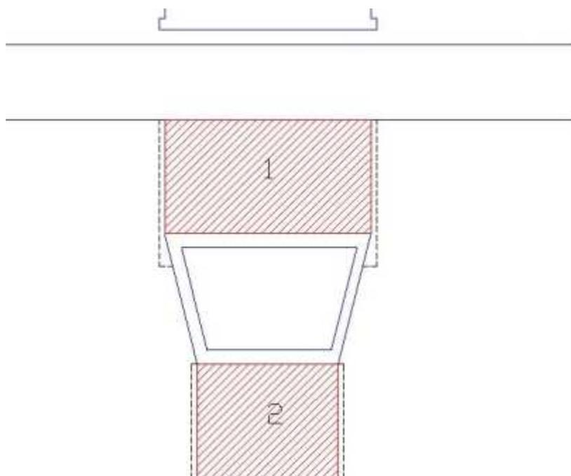
Découper dans du CP de 3 mm des morceaux rectangulaires s'engageant librement sans jeu dans les rainures des parties 1 et 2 (facultativement 2) ; exécuter une rainure non débouchante comme sur la photo du gabarit, et percer par cette rainure un trou dans le gabarit ; chaque pièce de réglage est fixée au gabarit par un boulon de type poëlier dont la hauteur de tête doit être en dessous du plan de la table, et par une rondelle et un écrou à oreilles.
