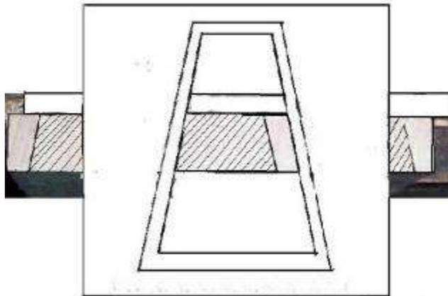
Le gabarit est aligné sur le tracé gauche, prêt à fraiser.
