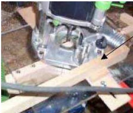
La pièce de bois ayant servi à régler la hauteur des queues mâles est insérée entre la butée de réglage et la partie arrondie de la défonceuse.
