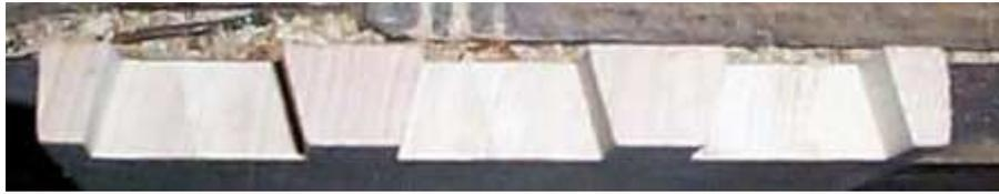
Si l'on observe les queues femelles, on s'aperçoit qu'elles ont une forme trapézoïdale dont les angles formés avec la face des pièces sont les mêmes que ceux de la fraise à queue d'aronde.
