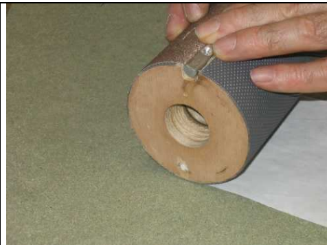
Fig.23 Mise en place du rond par dessus le premier bord. Bien enfoncer le papier dans la gorge.
