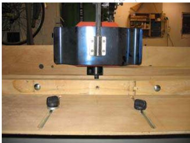
Le presseur à lame métallique est descendu juste pour laisser passer le bois à travailler. Ici un carretet de hêtre 70x70.
