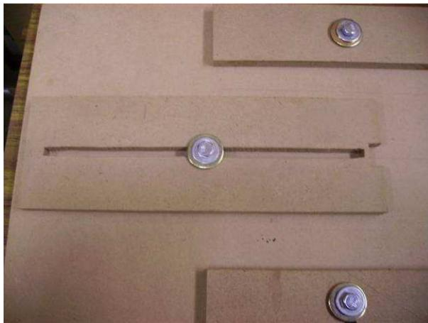
La butée arrière avec son encoche pour visualiser les axes du gabarit et de la façade aura une glissière relativement longue pour s'adapter aux différentes largeurs de façade
