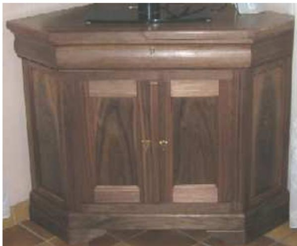
Pour réaliser les corniches de ce meuble, je ne disposais que d'une toupie avec un arbre de 20 mm et un débattement de 60 mm.
