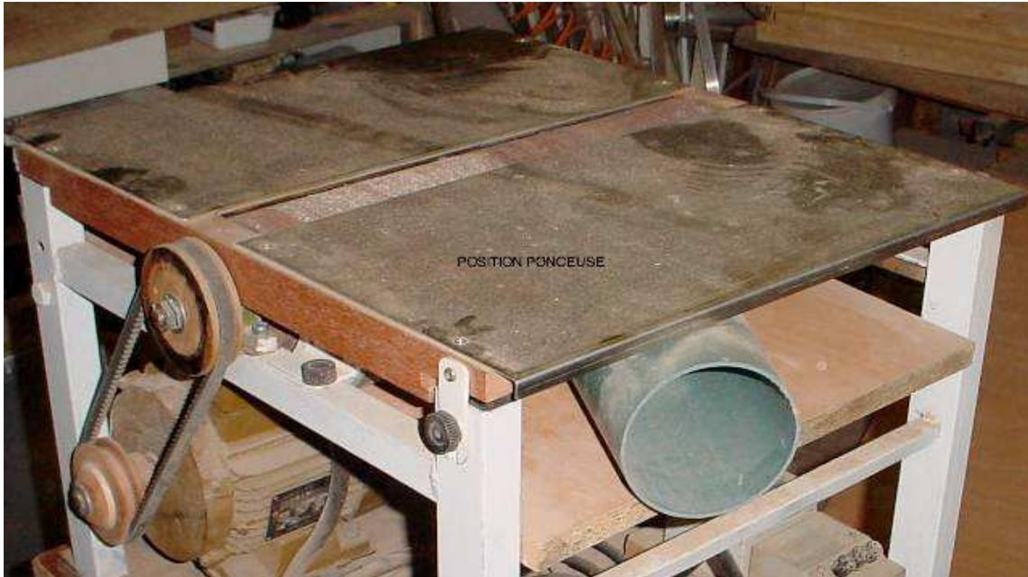
Cette configuration, permet l'utilisation en **mode ponceuse** : même principe de fonctionnement que la raboteuse
