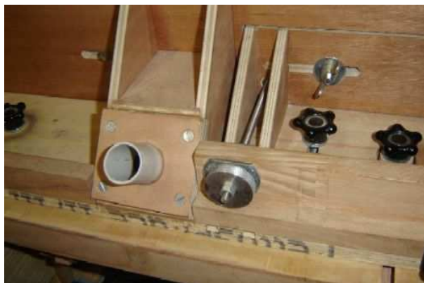
La platine d'adaptation de l'aspirateur à copeaux est interchangeable
