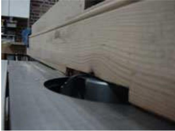
Pour la réalisation des plates bandes (avec un outil travaillant par en dessous), j'utilise une lame de lambris pour empêcher le panneau de rentrer dans l'outil en fin de passage.
