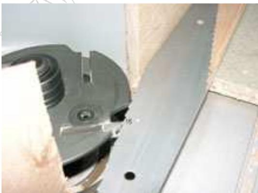
En prenant les précautions d'usage, démonter les disques et placer le disque à rainer. Régler la hauteur sur le tenon du contre profil. Régler la profondeur à 15 mm.
