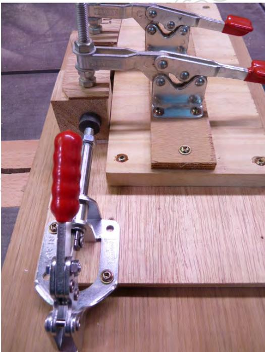
Le morceau de bois est bridé sur le gabarit. On peut rajouter une sauterelle travaillant en poussée qui coïncera le morceau de bois contre la butée de sortie.
