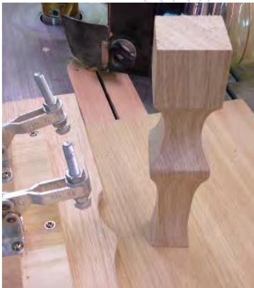
Pour réaliser le pied ci-contre, il sera nécessaire de fabriquer un gabarit assez simple.
