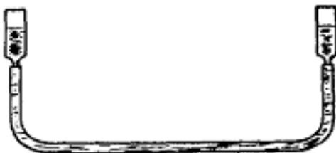
Il se compose d'un tube de caoutchouc de 8 à 10 de longueur et de deux fioles de verre. Le tuyau est rempli d'eau qui se stabilise. En traçant deux repères sur le mur à la hauteur de l'eau, puis en joignant ces repères au cordeau, on trace une droite de niveau. C'est une application des vases communicants.
