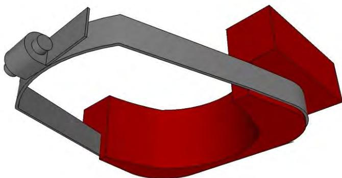
Le collier : Cette pièce doit, bien sûr, être adaptée à la forme de la perceuse. La fixation par vis permet, en insérant, par exemple, un morceau de placage ou un bout de bristol de rectifier la verticalité d'avant en arrière et, grâce à des trous oblongs on pourra rectifier la verticalité de gauche à droite.
