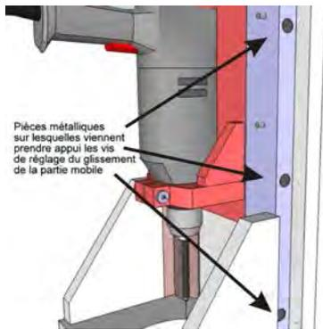
Afin que les trois vis de réglage n'abiment pas le chant de la coulisse, on aura soin, face à ces vis, d'insérer et de coller à la colle bi-composants, des rondelles métalliques.
