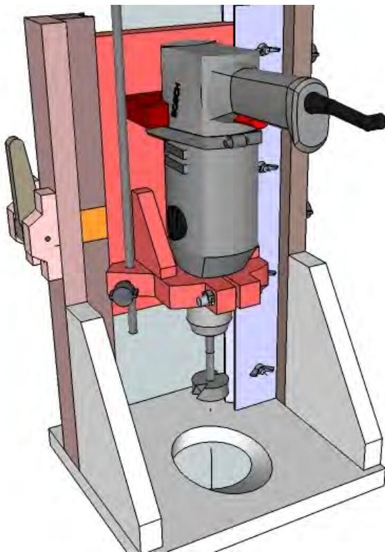
J'ai souvent vu sur les divers forums que je fréquente des questions de « boiseux » qui demandaient comment percer bien verticalement à une distance que ne permettait pas un pied fixe ou même faire des trous sur les bords d'un panneau trop grand pour être manipulé avec précision comme par exemple percer des logements de charnières invisibles sur des portes de grandes dimensions.
