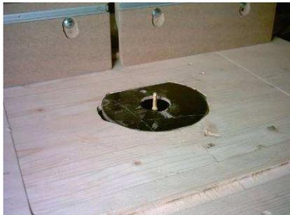
Une autre défonceuse. Vous pouvez remarquer que les défonceuses sont montées sans plaque support afin de préserver la hauteur de plongée. La semelle de la défonceuse est donc au niveau du dessus de la table.
