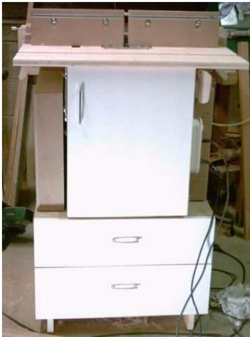
Cette table multi-fonctions est en réalité une table de défonceuse adaptée pour l'emploi de beaucoup d'autres outillages électriques.
