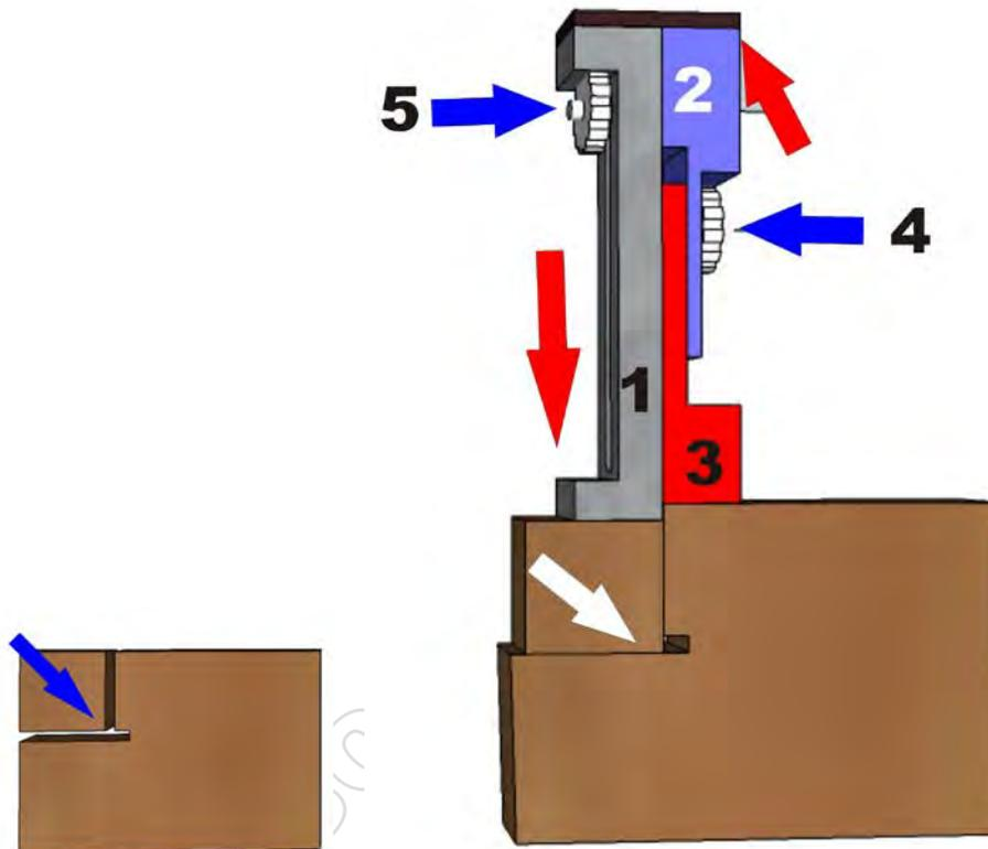
On bloque bien la pièce 2 contre la butée noire (flèche rouge en haut, à droite) et on la fixe à l'aide de l'écrou moleté (5).
