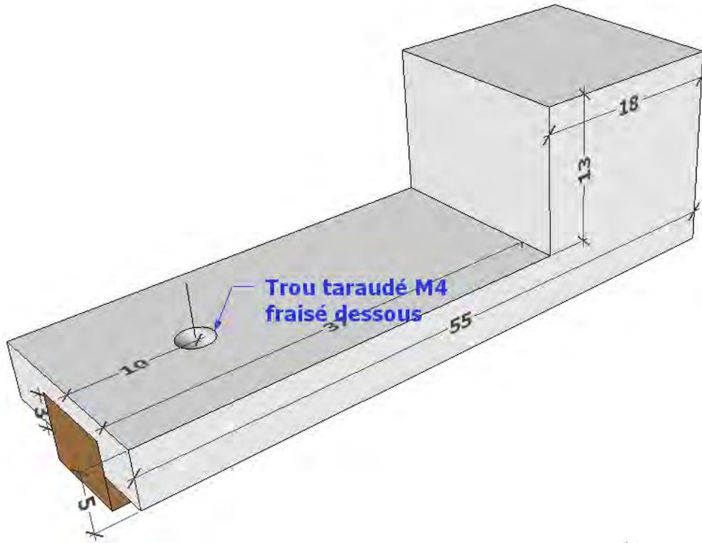
J'avais des barres carrée en hêtre de 18 x 18 mm. Au lieu de fraiser de chaque côté afin de laisser 2 ou 3 mm pour le coulisement dans la rainure de la base, j'ai préféré faire une rainure de 8 mm sur 3 de profondeur sur toute la longueur de la barre et de coller une languette dans la rainure de la pièce du milieu et du dessus (en brun sur les dessins). Ce qui, accessoirement m'a facilité la fabrication.
