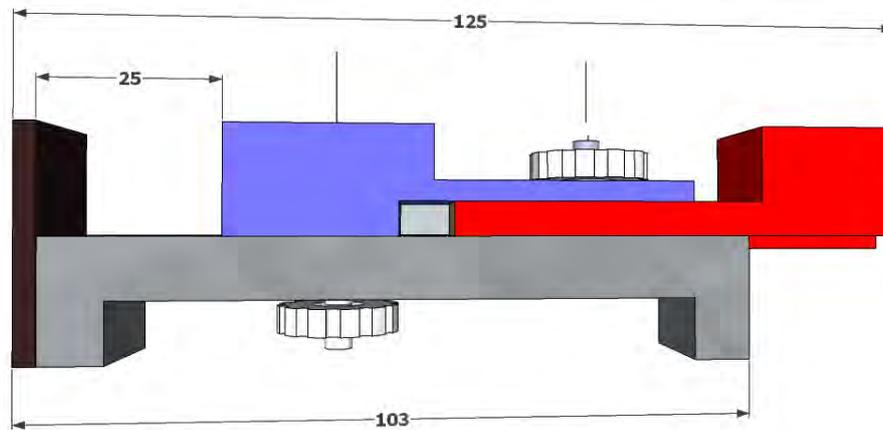
Comme vous pouvez le remarquer, la partie supérieure mesure 125 mm et celle d'en dessous 103 mm soit une différence 22 mm, (25 mm, largeur du bois – 3 mm du trait de scie).
