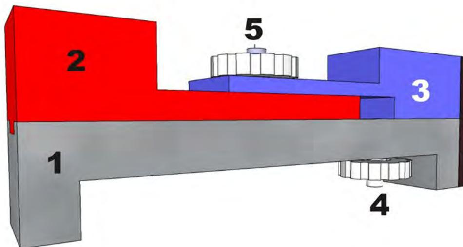
L'appareil se compose de 3 parties : une base (1) munie à un bout d'une butée double. (à droite, en gris) ; une partie intermédiaire (2) qui coulisse sur la base et enfin la partie supérieure (3) . Les pièces 2 et 3 peuvent coulisser l'une sur l'autre et être solidarisées grâce à l'écrou moleté (5).
