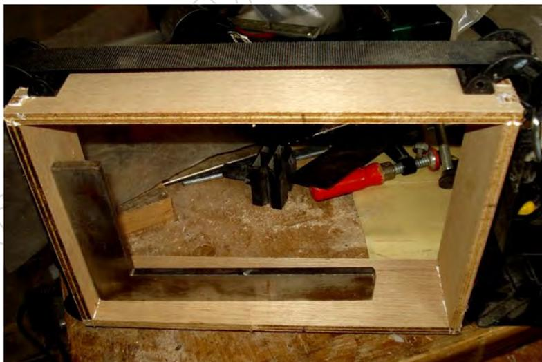
Détails des queues droites après nettoyage. Remarquez la précision et la propreté des découpes (dans du contreplaqué !). J'ai lu quelquepart que le contreplaqué et le MDF ne se prêtait pas à l'assemblage par queues droites. (À la défonceuse, c'est certain !)
