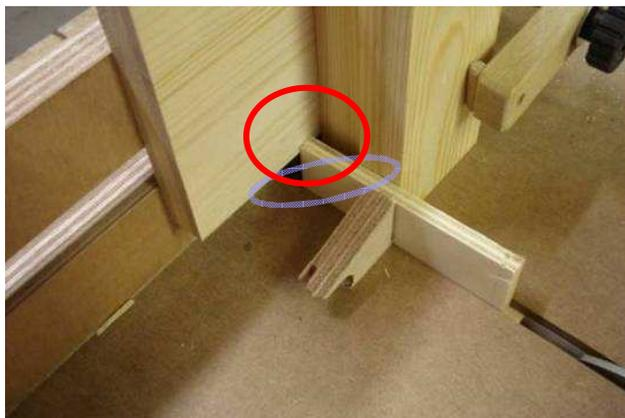
Reculer de 8 mm la partie mobile de l'appareil sur laquelle sont fixées les 4 planches à fraiser, (juste 1 tour de manivelle dans le sens horaire). Desserrez la sauterelle et venez aligner les 2 planches devant former la largeur (ou les 2 autres) contre la petite butée. Re-serrez la sauterelle et enlevez la butée.
