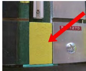
Enfin, une autre est spécifique. Elle mesure 55 x 29 et comporte un arrêt vertical en PVC (45 x 12), vissé sur l'épaisseur d'un petit côté. Elle se place contre la règle perpendiculaire.
