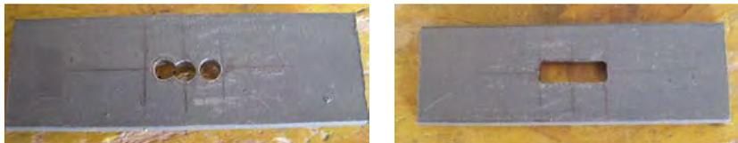
Emboîter les deux pièces et les souder. Éliminer les épaisseurs de soudure, rendre le fer brillant. Contrôler le coulisement de la pièce dans la rainure du rail.
