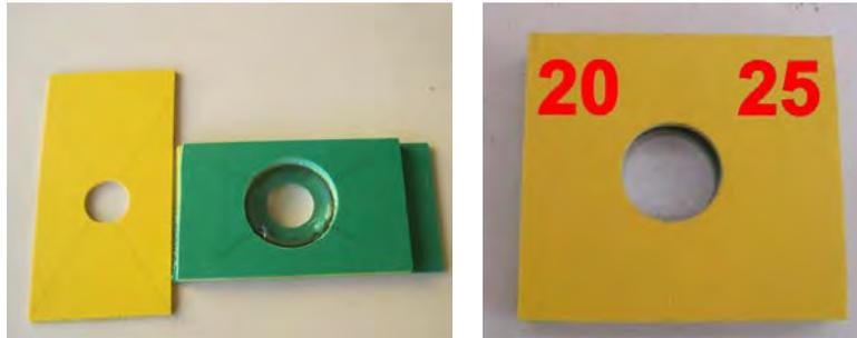
Coller le PVC percé à 40 avec le verre entre les deux morceaux percés à 20 en alternant les couleurs. Après séchage, couper à 65 (attention, le verre n'est pas centré).
