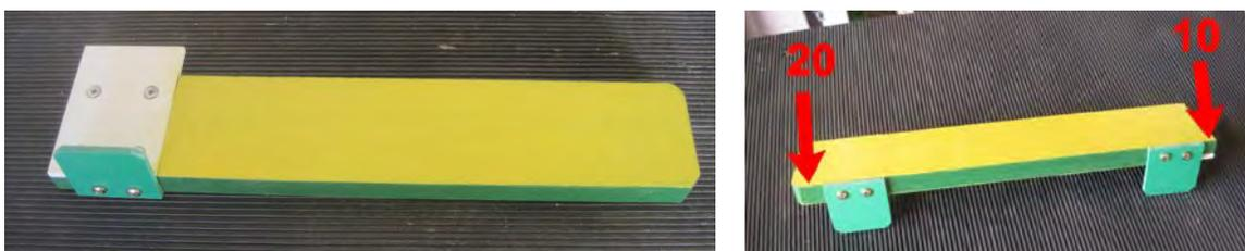
Mettre en place la cale sur la table avec deux cales anti-basculement de 70 x 50 et une pièce martyr.
