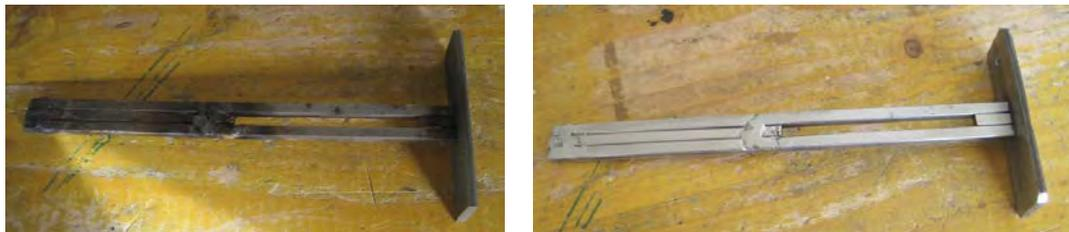
Débiter deux bandes de PVC e=1 et les coller au double face de part et d'autre. Percer une série de trous au  $\text{Ø}3$ . Façonner la rectangle central à la lime. Contrôler de nouveau le bon coulisement.
