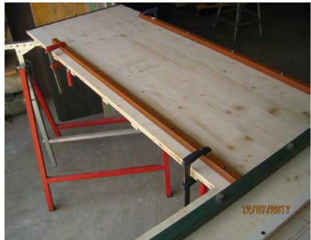
Il doit rester 260 mm entre l'extrémité des renforts et le bord gauche de la table.
