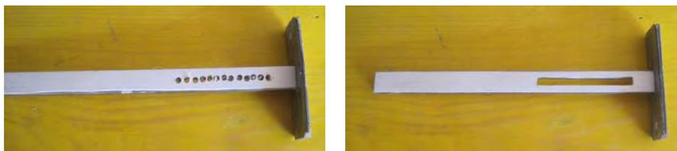
Mettre en place la pièce dans la rainure du rail et percer ce dernier au  $\text{Ø}4$  à 15 de l'extrémité droite (la pièce sert de gabarit pour percer bien au centre). Fraiser le dessus du rail.
