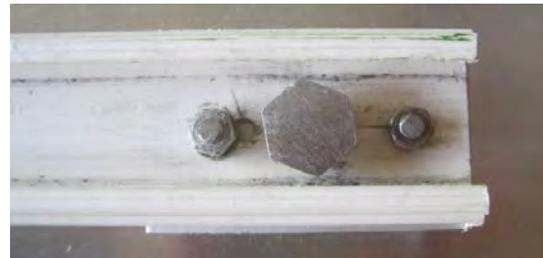
Dans un mètre-ruban de 13, débiter un morceau des graduations 7 à 991 (visibles). Percer 6 trous de fixation régulièrement espacés au  $\varnothing 2,5$  (le premier, d'origine, étant à agrandir). Positionner le mètre sur la bande de 35 de telle sorte que sa graduation 1 soit à 85 du bord avant de la table.
