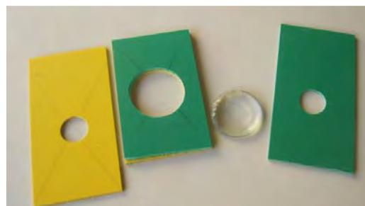
PVC e=3, débiter deux morceaux de 100 x 60. Les coller (colle PVC) et les percer au centre au Ø40 et PVC e=3, débiter deux morceaux de 120 x 60 et les percer au centre au Ø20, en alternant les couleurs.
