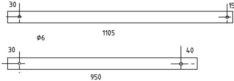
Pour le renfort long, débiter un morceau de 1105. Percer un trou central Ø6 à 15 d'une extrémité et à 30 de l'autre. Il est représenté en vert sur le schéma.
