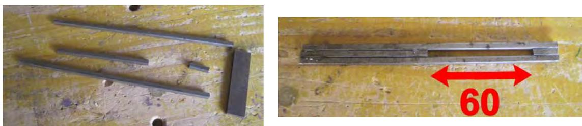
Dans du fer plat de 20, débiter un morceau de 60 de longueur. Percer trois trous  $\text{Ø}3,5$  au centre. Les relier et façonner à la lime un rectangle central de 4 x 12.
