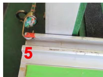
Le sandow gauche mesure 200 de longueur. Il est constitué par deux crochets et un élastique au  $\text{Ø}4$ . Son point d'attache arrière, un piton à œil, est à 25 du bord de la table. Au repos, il est maintenu par un autre piton à œil. La forme du crochet fixe a été modifiée avec une pince.
