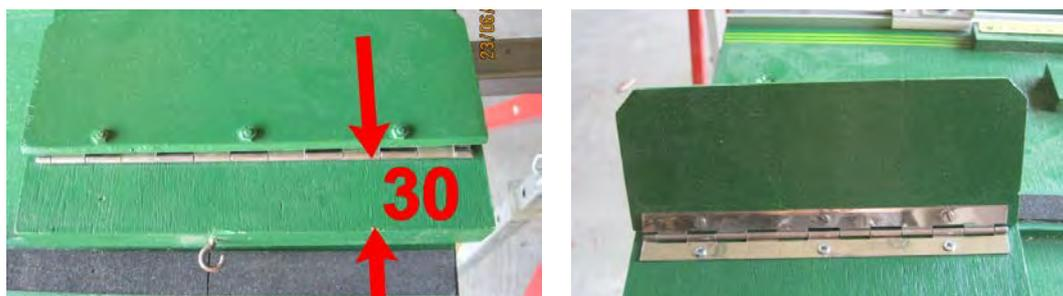
Visser les deux charnières dégonnables au fond, contre la dernière bande caoutchoutée. Ajouter sur le dessus du support des bandes en plastique (blanches sur la photo) pour y appuyer la scie.
