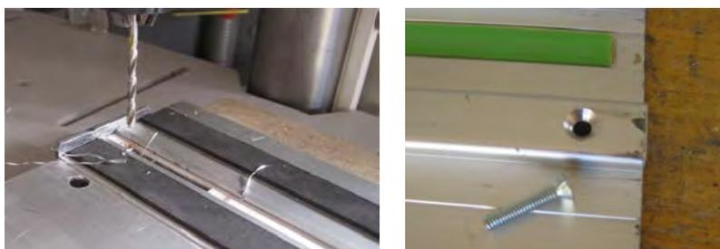
Utiliser un boulon de 4x20, muni en dessous d'une large rondelle et d'un écrou papillon.
