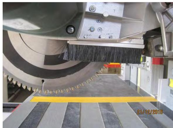
Au fur et à mesure du recul de la lame, ils pénètrent tous deux progressivement à l'intérieur du collecteur arrière.
