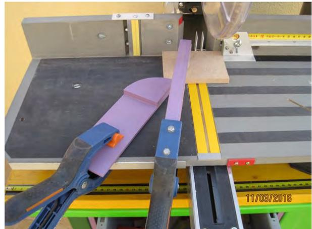
Sur le dessous, ces cales sont équipées de papier verre. En serrant avec la pince, on a donc un contact papier de verre contre papier de verre : résultat, ça ne bouge pas ! Enfin, si la longueur de la pièce le permet, une troisième pince vient renforcer le serrage à l'extrémité gauche du plateau.
