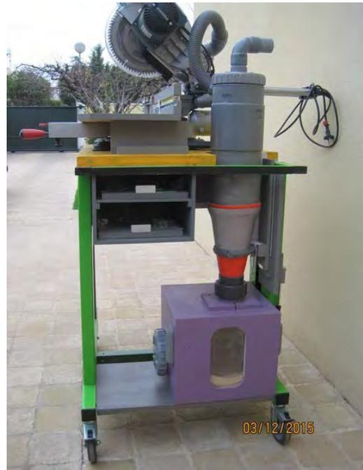
L'encombrement est réduit au minimum. L'ensemble est monté sur un chariot muni de 4 roulettes directionnelles à frein, assurant la stabilité lors du travail.
