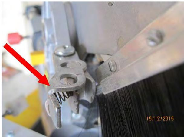
Ajouté sur la butée de profondeur, il permet de manière automatique d'enclencher la limitation pré-réglée de la profondeur de la lame. On évite ainsi de malencontreusement entailler le plateau.
