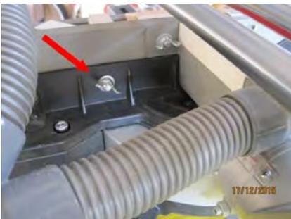
Le plateau, rapidement démontable (4 vis), permet un retour aisé à la machine d'origine.
