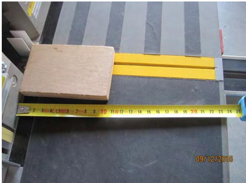
Au-delà, c'est du "débit" car la précision est forcément moindre (voir Réglage). J'ai gardé une largeur de plateau de 220 pour éviter de trop souvent le démonter. D'autre part, au delà de 30 mm d'épaisseur, c'est le bridage des pièces qui risque de poser problème. Par contre, en longueur, il n'y a pas de limite ; mais la précision est inversement proportionnelle à la longueur : plus c'est long, moins c'est précis.
