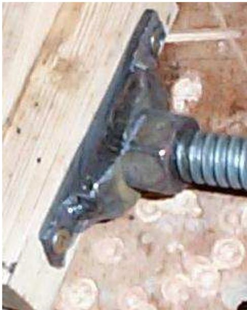
L'écrou de roue avec sa rondelle sur laquelle a été soudé un bout de fer plat percé pour pouvoir y fixer un mors en bois tendre (la rondelle a été coupée à la largeur de l'écrou).
