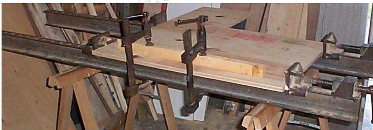
On s'aperçoit vite que le collage d'un panneau nécessite la mobilisation de plusieurs serre-joints et ce qui n'est pas négligeable : encombre l'atelier le temps du collage.
