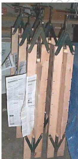
Une fois les panneaux serrés, il est possible de mettre l'ensemble debout ce qui permet de libérer de la place dans l'atelier
