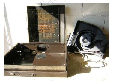
Ouvrir la hotte, pour la nettoyer à fond. Profitez-en pour remplacer l'ancien filtre par un neuf; ne pas hésiter à mettre plusieurs couches
