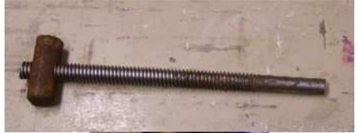
Un morceau de tige filetée de 150 mm de long percée et taraudée à un diamètre de 5 mm en bout permettra d'y fixer la rondelle.
