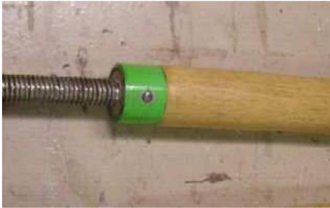
Une fois la virole et la tige filetée en place, le manche a été percé de part en part pour y introduire un morceau de clou, martelé (riveté) aux extrémités pour le maintenir en place.
