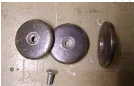
Pour le point d'appui, des rondelles épaisses percées et fraisées en leur centre conviendront parfaitement.
