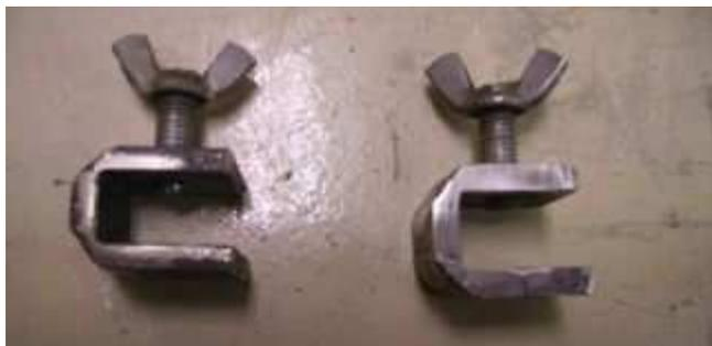
Pour réaliser deux pièces comme celle de droite, j'ai utilisé un morceau de fer plat :
