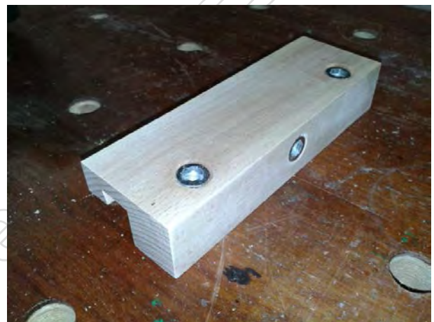
Perçage des trous et insertion des écrous noyés
