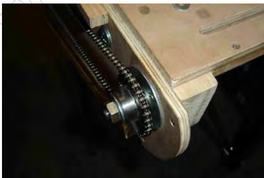
Une chaîne entraîne le guide parallèle
