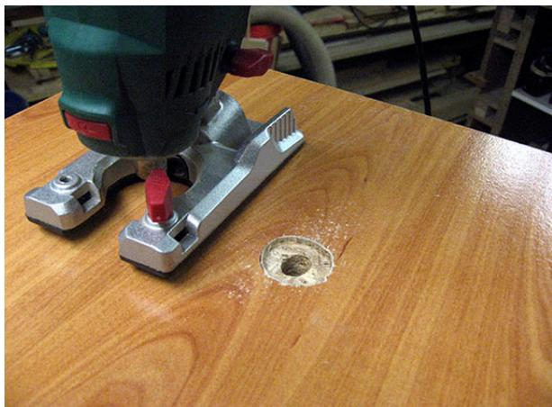
Démonter la base et la superposer avec le dessus, la marque du pointeau visible.
