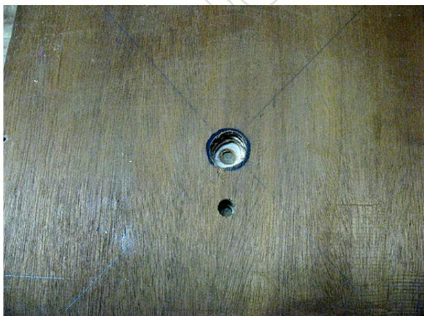
À partir de l'avant trou du côté de la **face intérieure du dessus**, avec une mèche bois de 10mm, percer un trou de profondeur 14mm, puis percer sur le reste de l'épaisseur un trou de D=6mm.
