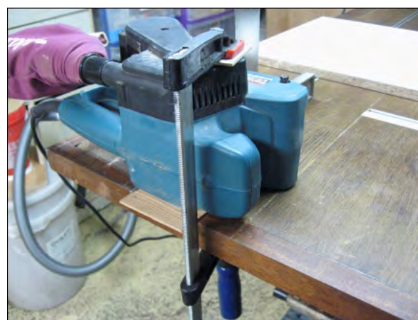
Fixation avec un serre-joints
