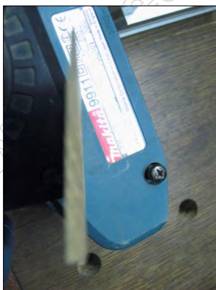
Fine cale pentée pour mettre de niveau si nécessaire
