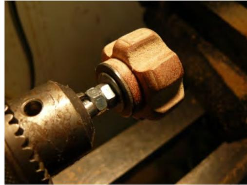
Ensuite je me sers d'une vis six pans M6 (ou M8) munie d'une rondelle large et de deux écrous de manière à créer un axe pour pouvoir tourner le bouton. Passons à la partie tournage pour « mettre au rond » et polir.
