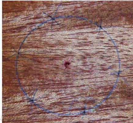
Un diamètre de 35 à 40mm est bien adapté pour des vis M6 ou M8
