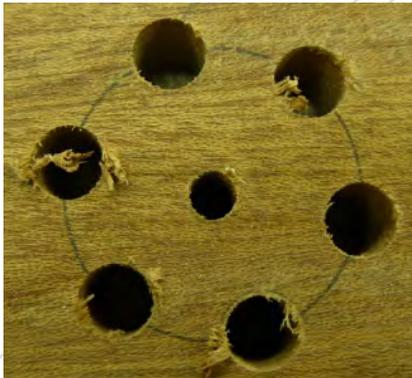
Ensuite perçage de l'axe central à 6,5mm (ou 8,5mm), puis des six trous pour la réalisation des « branches » au diamètre de 10mm,
