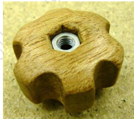
Une fois cette opération terminée il faut marquer nettement l'empreinte hexagonale soit à l'aide du bédane de 6mm ou d'un couteau à tracer, puis creuser l'empreinte sur 8 à 10 mm de profondeur. Une fois l'opération terminée, insérer l'écrou (le coller s'il y a trop de jeu) et appliquer la finition de votre choix.
